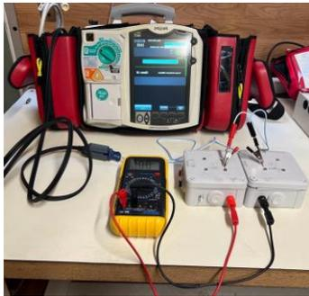
Figure 8 : Électrodes de défibrillation branchée au testeur low-tech
