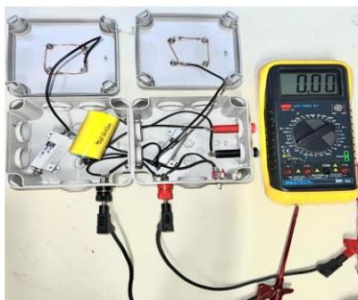
Figure 7 : Schéma du testeur branché au multimètre
