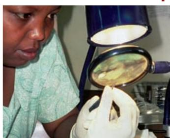
Vérifiez l'alignement et testez le tranchant ou la pointe des instruments, avec un grossissement et un éclairage adéquats
